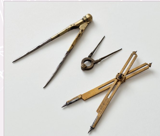
Arbeitsgeräte des Architekten: Stechzirkel (um 1600), Einhand-Zirkel (um 1500) und Reduktionszirkel (Ende 17. Jh.), Städtisches Museum Schloss Rheydt, Mönchengladbach.
